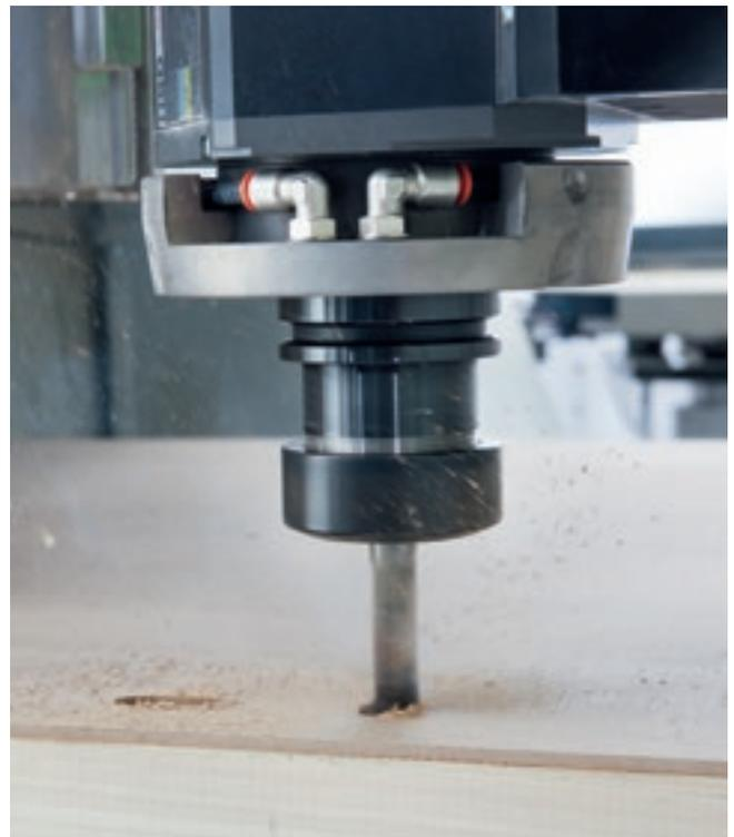
A Rover K Smart é equipada com 3 ou 4 eixos independentes e interpolados e pode ser equipada com agregados capazes de executar todas os processamentos seja em painéis que em peças de madeira maciça.
