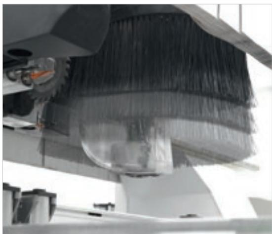
A coifa de aspiração ajustável em 6 posições permite a limpeza constante do produto e do ar circundante.
